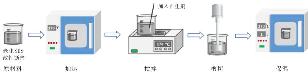
图4 再生SBS改性沥青制备流程图
