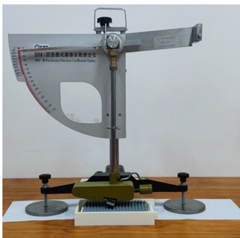
图4 摆式摩擦试验
