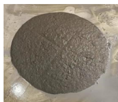
图9 非预混料振动搅拌试验样本
