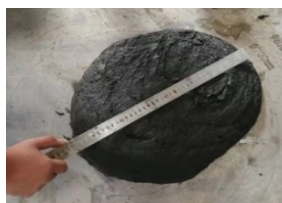
图10 非预混料非振动搅拌试验样本
