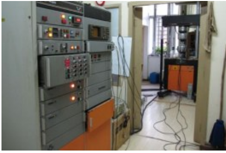
(a) 电液伺服疲劳试验机
