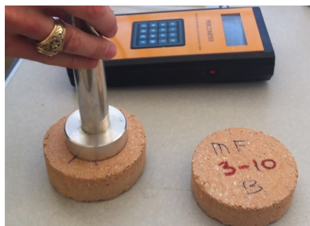
图2 压实土样的介电常数测试仪读数
