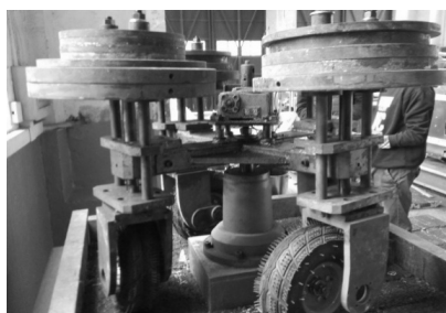
图 2 小型加速加载试验机
