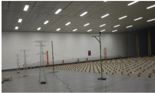
图5 塔线耦联体系气弹模型
