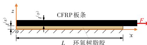
(b) 平面应变模型的表面粘贴 CFRP 与环氧树脂胶
