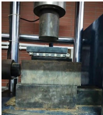
图2 大型直剪试验
