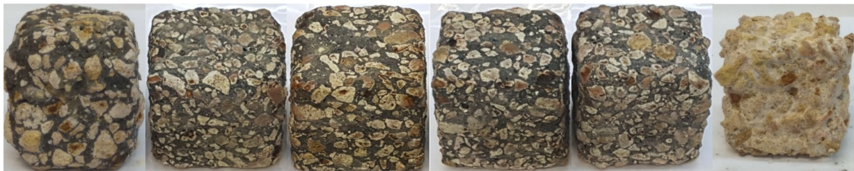
(a) 0% 纳米 SiO_2 (b) 1.0% 纳米 SiO_2 (c) 2.5% 纳米 SiO_2 (d) 5.0% 纳米 SiO_2 (e) 7.5% 纳米 SiO_2 (f) OPC
