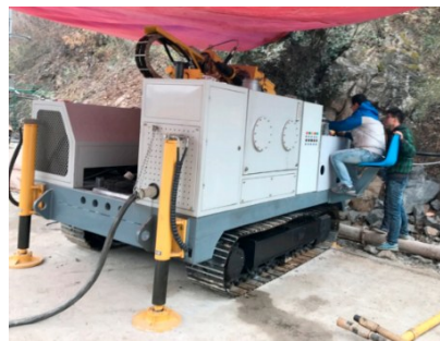
图2 XCY-1 型岩体力学参数数字钻系统
