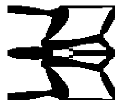
图 5 方法 2 获得的两输入两输出柔顺机构优化构型
