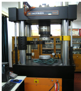
图 2 液压万能试验机
