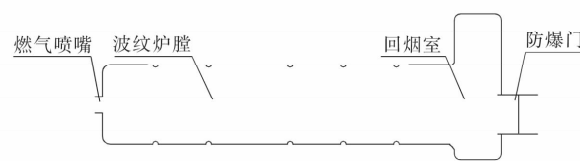
图 1 2.8 MW 热水锅炉燃烧室结构图
